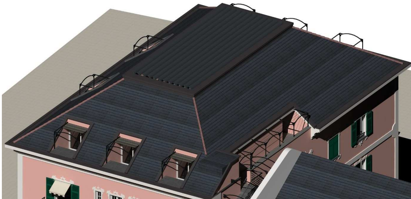
Vista assonometrica della schermatura a lamelle inclinate metalliche color grigio ardesia
